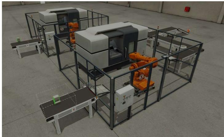
Steuerungen verknüpft werden. Die Software unterstützt Anlagen der Hersteller Allen-Bradley und Siemens sowie Modbus, OPC, WinSPS und Automgen. Die physisch vorhandene SPS kann über ein Rechnernetz mit der Simulation verbunden werden. Die Software auf der SPS steuert die Anlage und die Simulationssoftware visualisiert das Ergebnis in der virtuellen Fabrik durch Bewegung und Animation.
